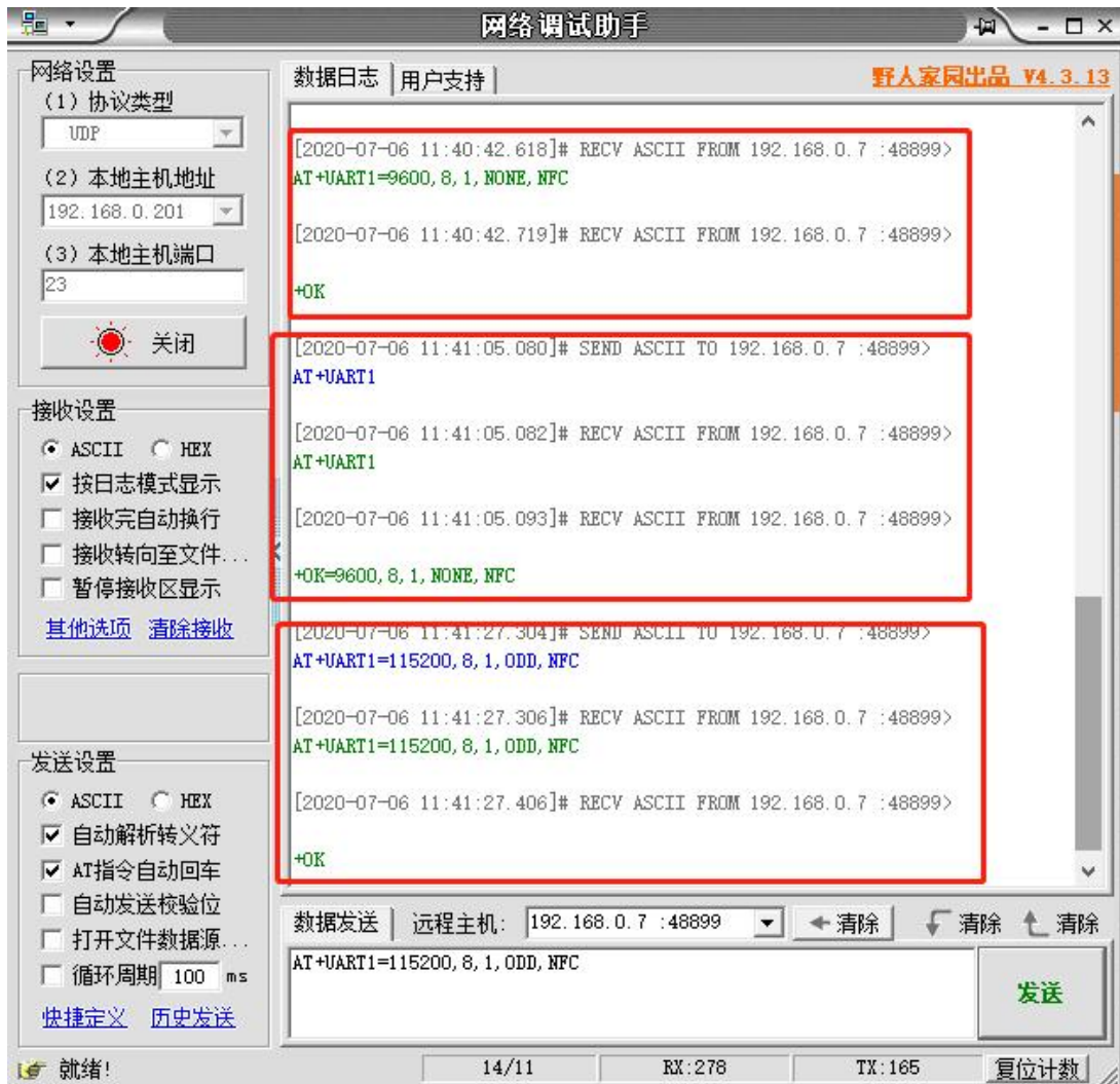
图 3 网络 AT 指令设置和查询
