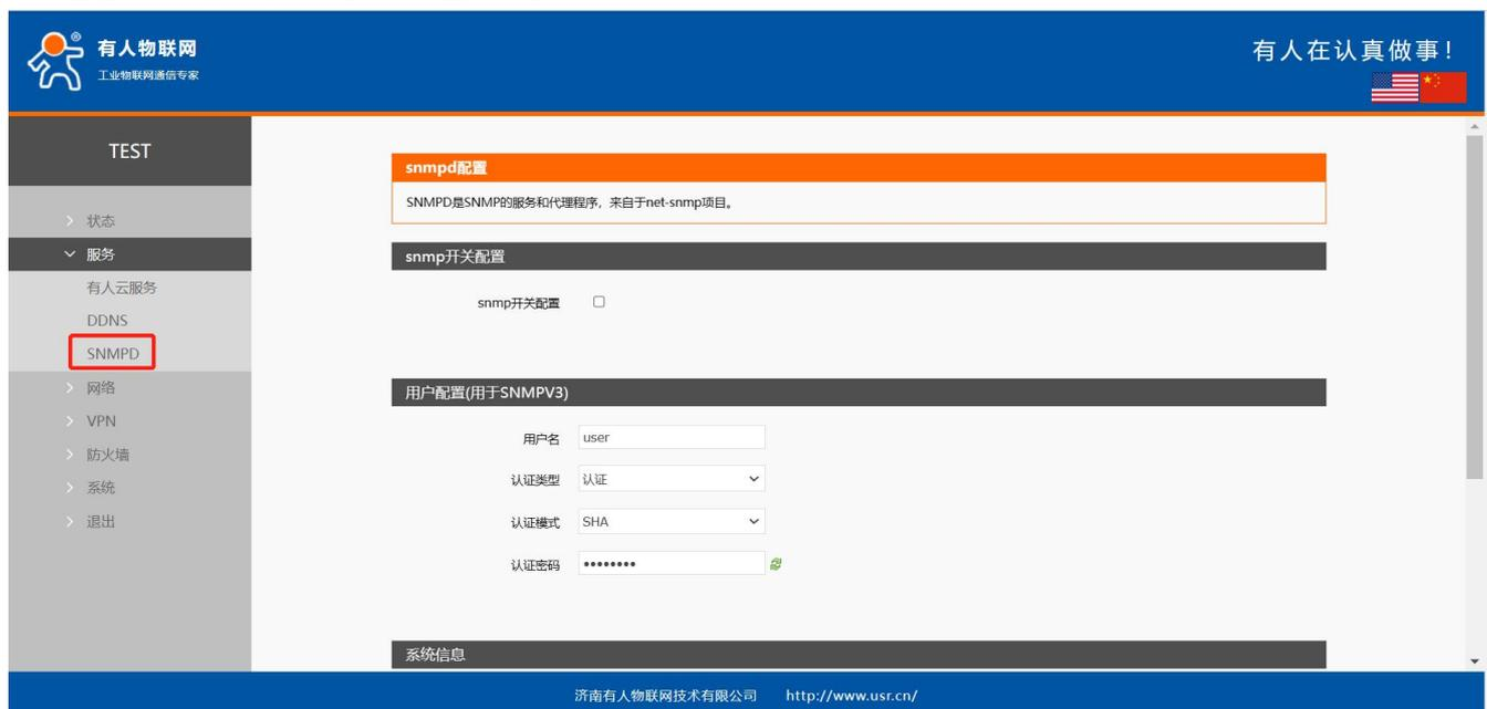
图 129 SNMP 服务设置界面
