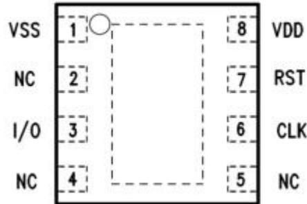
图 22 C2x2eSIM 芯片管脚示意 (TOP VIEW)
