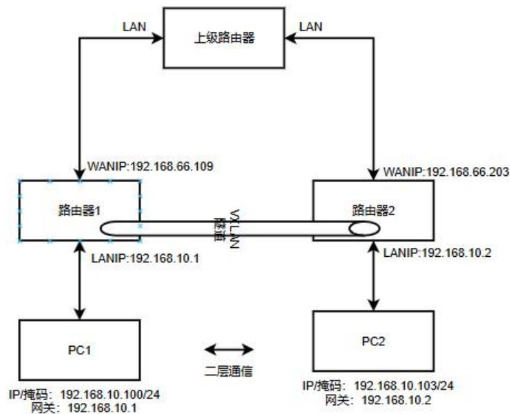
图 52 点对点桥接方式
