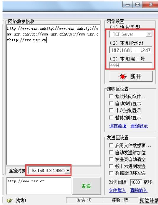
图 102 VPN+端口映射测试图
