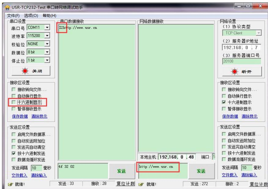
图 36. Index 功能数据传输示例图
