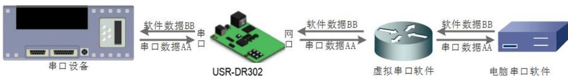
通过使用配套软件 VCOM(虚拟串口)，接收指定虚拟串口的数据，然后把该数据以网络数据的形式发送出去，从而解决 PC 端软件为串口方式而无法和联网设备通讯的问题，方便用户使用。
