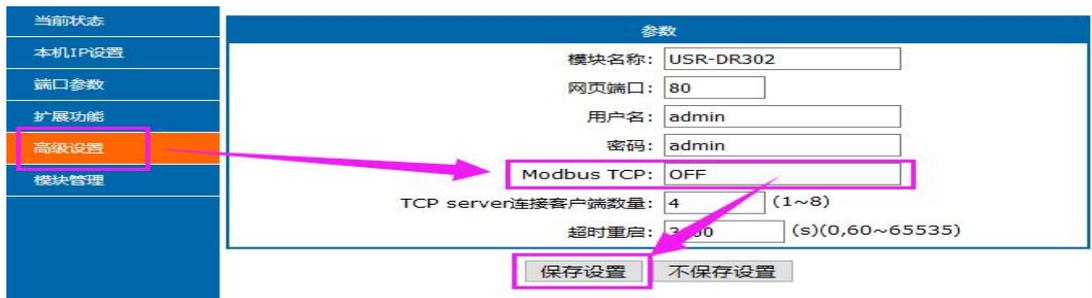
在 Mod bus TCP 一栏中填写（不区分大小写）“on”：开启功能，填写“off”：关闭功能，默认关闭。
